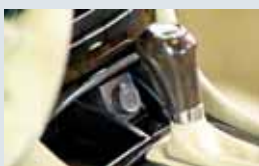
Ročni oddajnik HSZ lahko vgradite neopazno na fiksno mesto v avtomobilu. Potisnjen v ohišje cigaretnega vžigalnika je ročni oddajnik hitro dosegljiv in priročen za uporabo.
